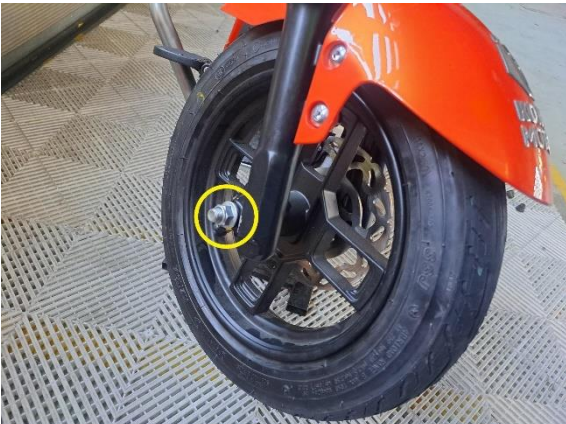
Irrota etuakselin lukitusmutteri (kiintoavain 14 mm, 17 mm).
