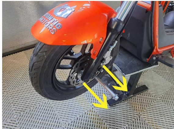
Vedä etuakseli pois. Kannattele samalla etupyörää, ettei pyörä pääse putoamaan hallitsemattomasti pois paikoiltaan.
